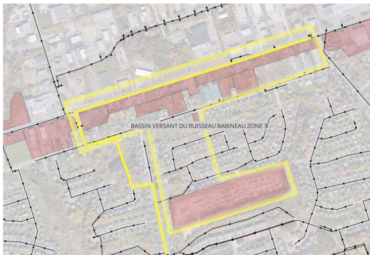
Figure 35: Zones clés nécessitant une modernisation des infrastructures d'égouts dans le bassin versant du ruisseau Babineau.
